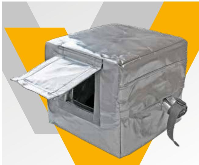
В зависимости от поставленной задачи термочехлы ТЭК-ТЕРМ могут быть изготовлены в пассивном исполнении (без нагревательных элементов) и применяться как средство защиты от атмосферных воздействий или снижения теплопотери (если оборудование или укрываемые элементы выделяют тепло), или в активном исполнении – оснащаться системой электрообогрева.
