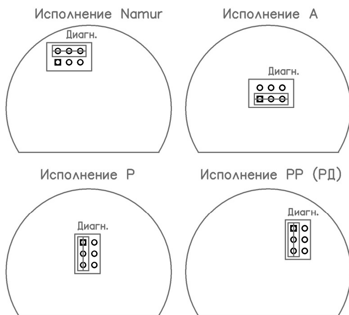
Рисунок 4. Положение перемычки при переключении сигнализатора в режим «Настройка порога»
