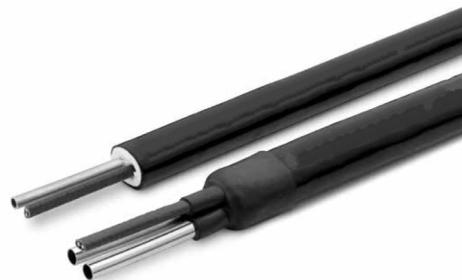
**ТЭК-ЛАЙН-Л** – трубки, обогреваемые «легким» тепловым спутником, нагревательным элементом является металлическая трубка теплоспутника, отделенная от технологической трубки слоем теплоизоляции, в основном применяется в случае обогрева высокотемпературным теплоносителем, ввиду наличия теплоизолятора температура в технологической трубке существенно ниже чем температура теплоносителя
