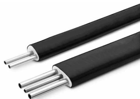
**ТЭК-ЛАЙН-Т** – трубки, обогреваемые «тяжелым» тепловым спутником, нагревательным элементом является металлическая трубка теплоспутника, проложенная в непосредственном контакте с технологической трубкой, в основном применяется в случае обогрева теплоносителем с относительно невысокой температурой, температура в технологических трубках практически равна температуре теплоносителя
