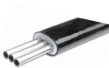
*Вышеуказанные типы трубок применяются в качестве импульсных линий датчиков давления и перепада давления, а также в качестве линий доставки пробы к анализаторам. В зависимости от поставленной задачи выполняют функцию защиты от замерзания или точного поддержания заданного температурного режима среды внутри трубок.*
